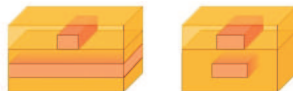
Die Aufspaltung der Referenzebene auf BOT in einzelne "Referenzleiter" erlaubt breitere Impedanzleiter auf TOP
