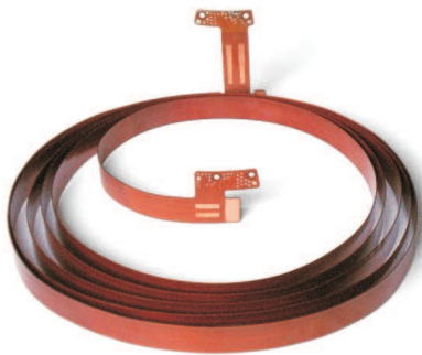
4 Meter langer Flex-Multilayer mit 4 Lagen
