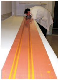
Opt. Kontrolle einer 4 Meter-Flex-Innenlage
