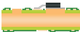
Aufbau einer SMD-Hochstromleiterplatte
