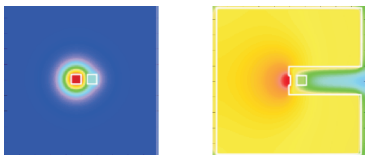
Thermosimulation einer 76mW-SMD-LED auf einem LED-Flex-Band, ohne und mit Kühlpad ( 10 \times 10 \text{ mm}^2 ); \Delta T_{max} = 220 \text{ K} bzw. 15 \text{ K}
