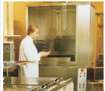
Hot-Oil-Levelling in den '80er Jahren
